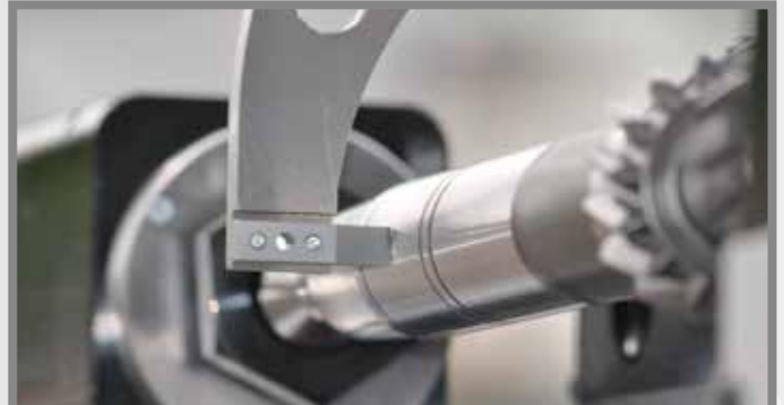
tastatori con contatti in widia
